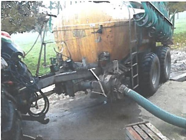
Ich schalte das Öldruck-Steuergerät ein, damit der Schneidekopf am Einfüllstutzen läuft. Danach schalte ich die 540 Zapfwelle ein und lasse die Zapfwelle mit 400 Umdrehungen in der Minute laufen. Ich steige aus dem Traktor und kuppel den Saugschauch an und öffne den Schieber am Fass. Wenn das Fass voll ist, schliesst es den Schieber automatisch und ich kuppel den Schlauch ab. Ich steige in den Traktor, nehme das Handgas retour und schalte die Zapfwelle und das Steuergerät aus.
